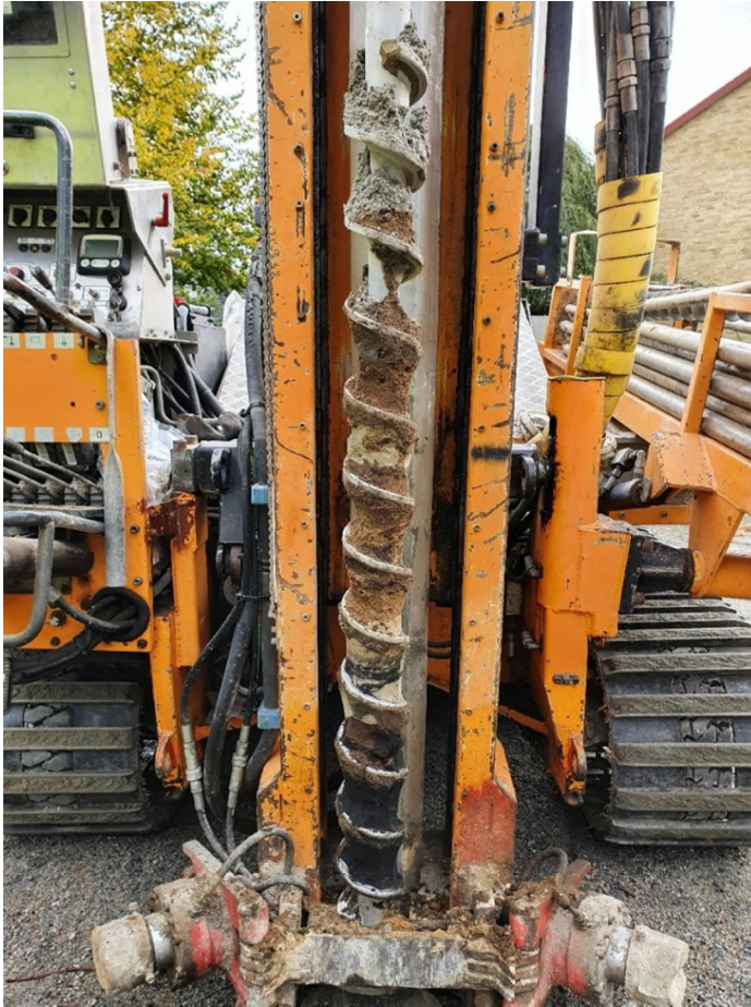
Figur 3. Provtagningssskruv i provpunkt 21T13 (0–1 m u my). Fyllningen är generellt omblandad och ett svart lager av sand påträffades de sista 20 cm på denna meter.
