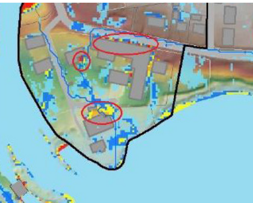
Karta från Tyréns översvämningsanalys som redovisar avrinningsytor och instängda ytor utifrån dagvattenöversvämmning från ett 100-årsregn.
