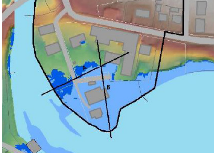
Kartor från Tyréns översvämningsanalys som redovisar översvämningszoner utifrån 100-årsflöde (kartan till vänster) och 200-årsflöde (kartan till höger). Den ljusblå färgen visar flödena söder om dämnet (+15,9 m ö h för 100 års flöde och +16,0 för 200-årsflöde) och den mörkblå färgen visar flödena norr om dämnet (+16,2 m ö h för 100-årsflöde och +16,3 för 200-årsflöde).
