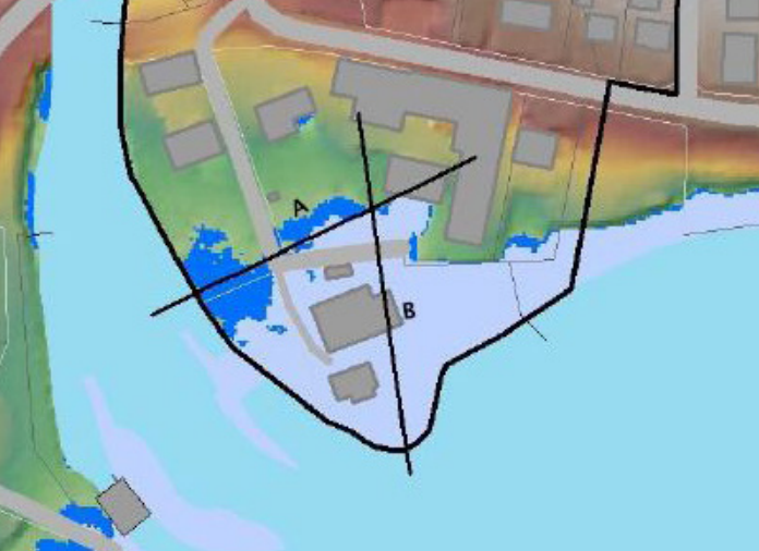
Kartor från Tyréns översvämningsanalys som redovisar översvämningszoner utifrån 100-årsflöde (kartan till vänster) och 200-årsflöde (kartan till höger). Den ljusblå färgen visar flödena söder om dämnet (+15,9 m ö h för 100 års flöde och +16,0 för 200-årsflöde) och den mörkblå färgen visar flödena norr om dämnet (+16,2 m ö h för 100-årsflöde och +16,3 för 200-årsflöde).
