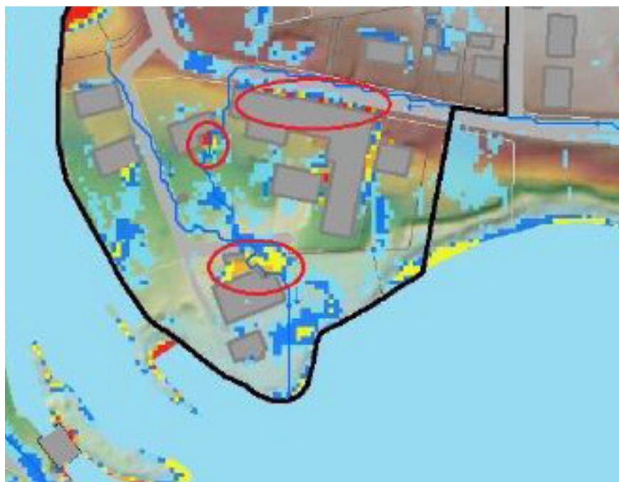
Karta från Tyréns översvämningsanalys som redovisar avrinningszoner och instängda ytor utifrån dagvattenöversvämmning från ett 100-årsregn.
