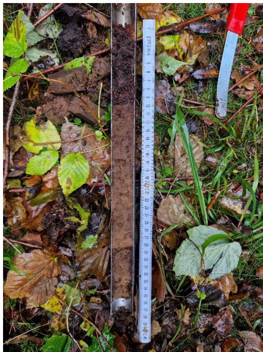
Figur 3. Foto som visar jordlagerföljd i de enskilda delpunkterna. Överst sågs ca 0,1 meter mörkbrun mulljord/humusjord och därunder ljusbrun sandmorän.
