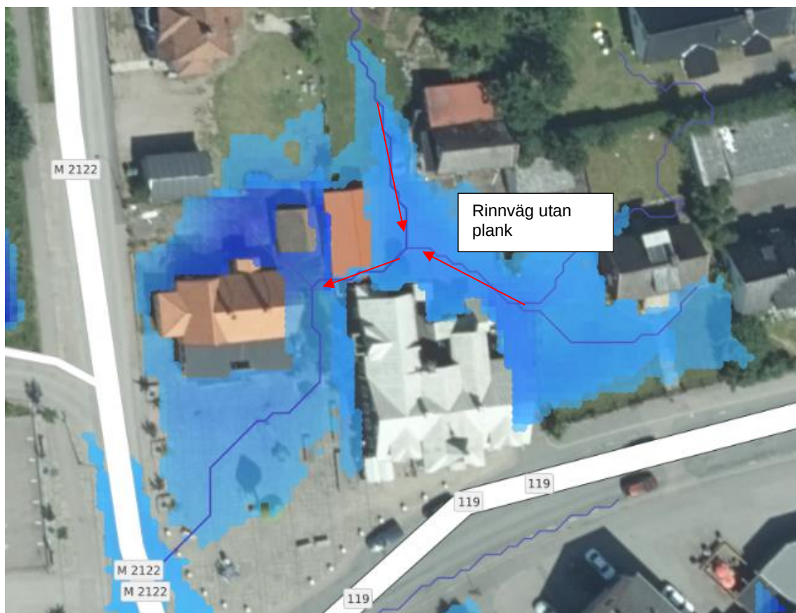
Figur 7: Flygbild över fastigheten med vattnets rinnvägar vid en skyfallshändelse. Röd pil pekar på vattnets rinnväg med avrinning från grannfastigheten utan plank. (Scalgo Live)
