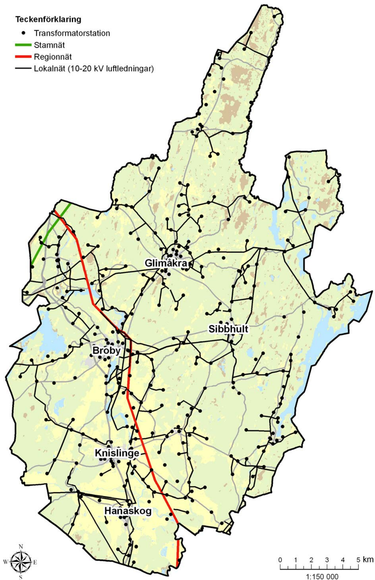
Figur 9: Kraftledningsnätet i Östra Göinge kommun
